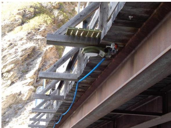
fig. 20 : capteur de niveau sous le pont du Gouret
