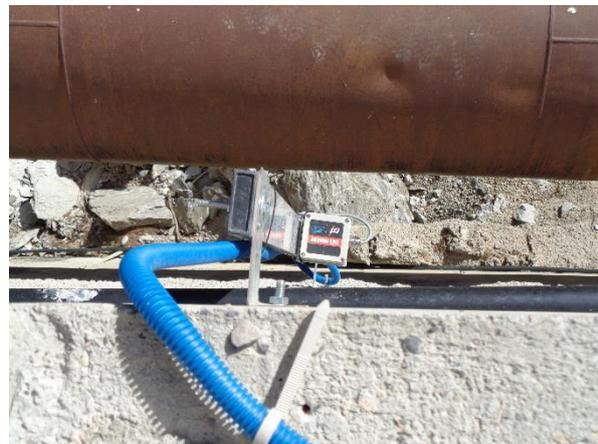
fig. 21 : clinomètre sur mur de soutènement aval de la RD
