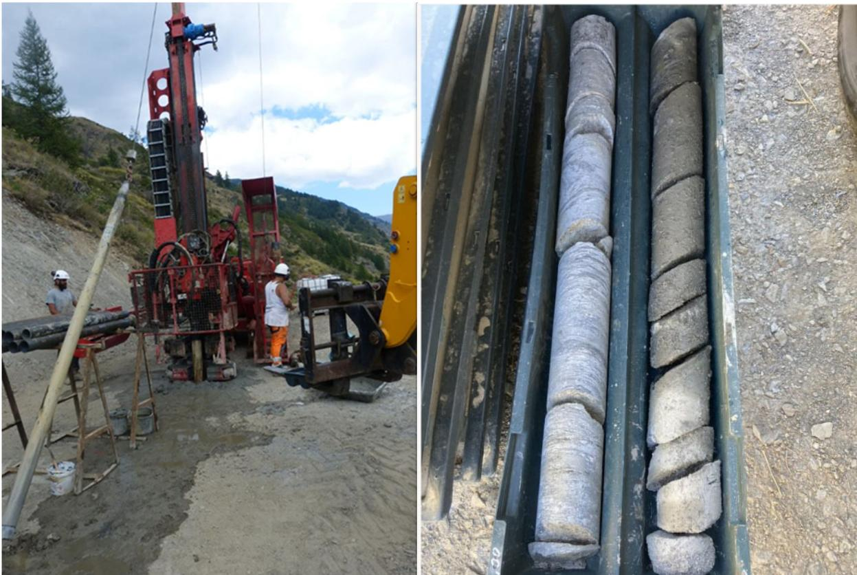
Figure 33 – Forage du Pas de l'Ours réalisé à l'été 2022 avec exemple de carotte prélevée
