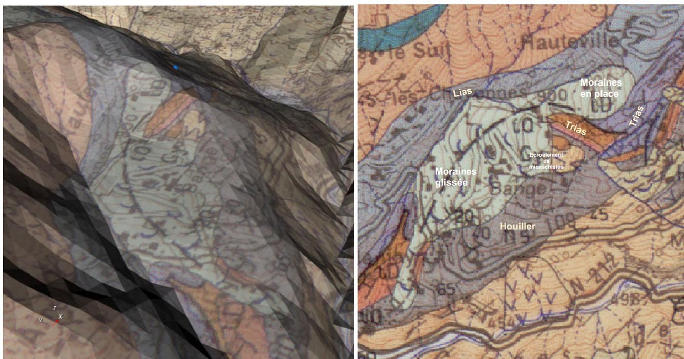
Figure 66 – A gauche, carte géologique au 1/50 000 drapée sur le fond topographique du secteur de Bange. A droite la carte géologique à plat avec description des polygones du secteur de Bange
