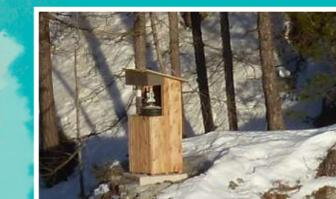
3 caméras ont été installées dans des guérites en bois pour surveiller l'évolution des compartiments est et ouest ainsi que le Guil en aval. Ces images ont deux utilisations : 1/ elles permettent de vérifier l'origine d'une alerte dans le dispositif de surveillance. 2/ elles sont analysées pour mesurer un déplacement.
