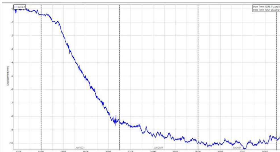
Figure 12 : accélération ponctuelle du fluage (à son maximum), passant d'un affaissement de 0,02 mm/jour à 1 mm/jour
