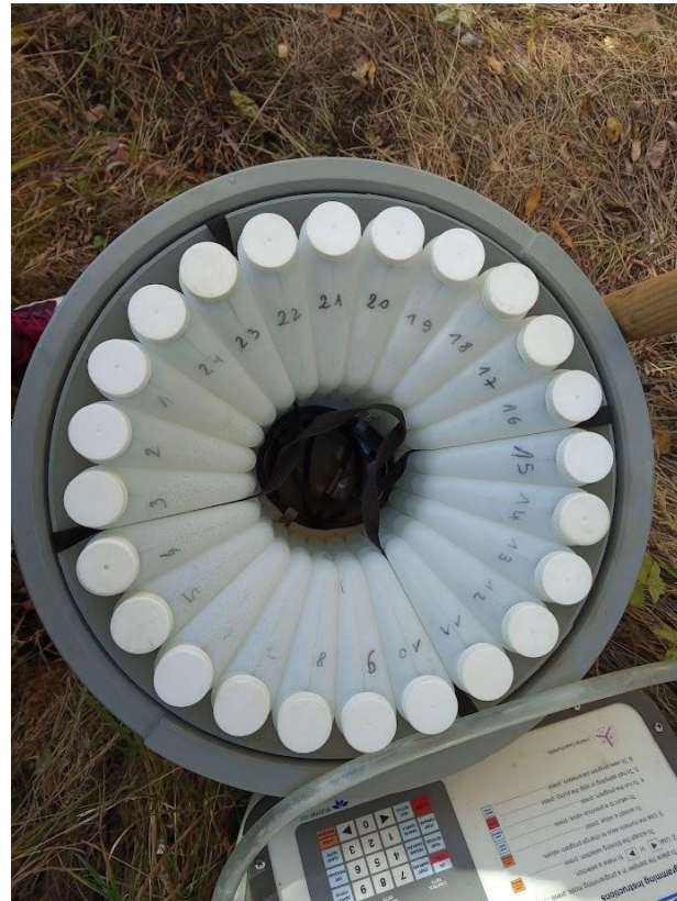
Figure 39 : A gauche, photo de l'ISCO (préleveur autonome mise en place à la source de la pause), au centre intérieur de l'ISCO avec les 24 échantillons à prélever ayant une contenance de 800 mL, et à droite l'appareil ISCO à mettre en marche pour lancer le prélèvement automatique des échantillons sur le terrain.
