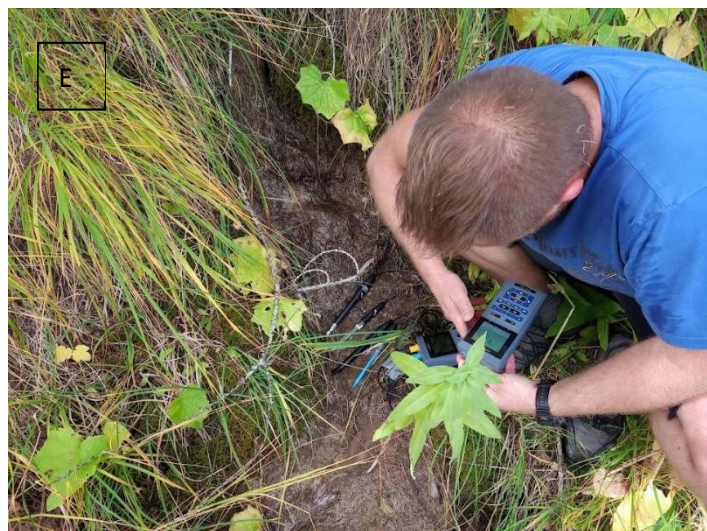
Figure 38 :Figure A prélèvement dans un captage particulier, Figure B sonde et appareil de mesure, figure C mesure du niveau d'eau dans un piézomètre, figures D et E mesures des paramètres physico chimiques.
