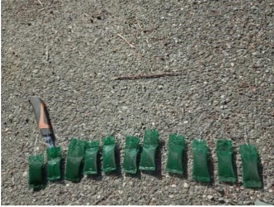
Figure 22 : Fluocapteurs, aux charbons actifs, apte à fixer les colorants
