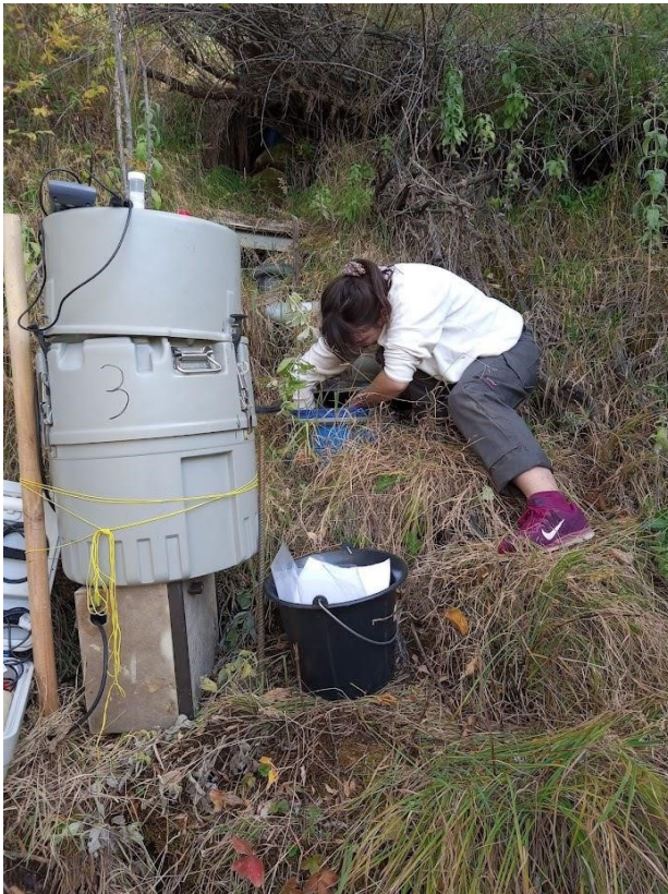
Figure 39 : A gauche, photo de l'ISCO (préleveur autonome mise en place à la source de la pause), au centre intérieur de l'ISCO avec les 24 échantillons à prélever ayant une contenance de 800 mL, et à droite l'appareil ISCO à mettre en marche pour lancer le prélèvement automatique des échantillons sur le terrain.
