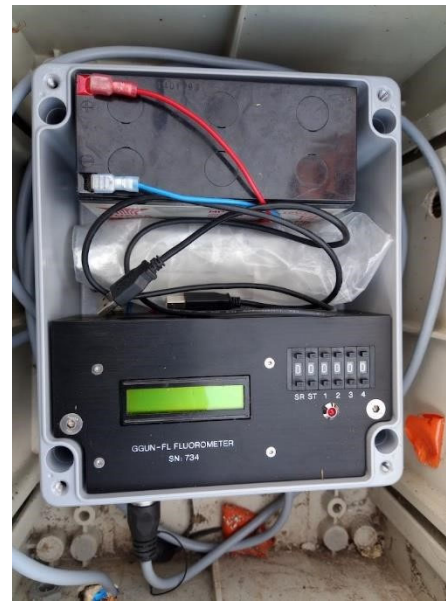
Figure 23 : GGUN, à droite la notice d'utilisation GGUN et à gauche le GGUN avec la batterie.
