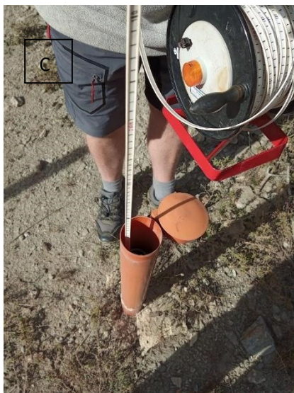
Figure 38 :Figure A prélèvement dans un captage particulier, Figure B sonde et appareil de mesure, figure C mesure du niveau d'eau dans un piézomètre, figures D et E mesures des paramètres physico chimiques.
