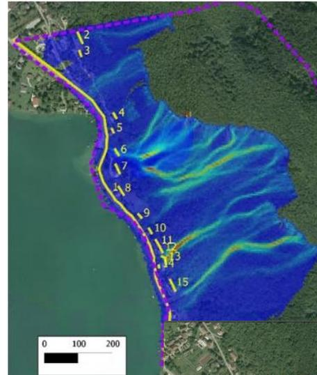
Energie maximale des blocs atteignant les écrans de contrôle
