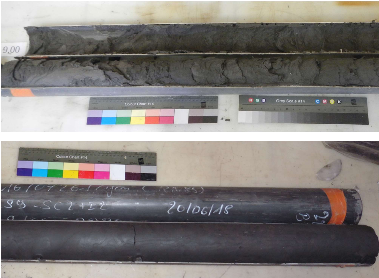
Figure 2 : (en haut) Prélèvement fortement altéré à l'ouverture de la carotte par adhérence sur la gaine (sondage S8-SC2 de 9.00 à 10.50 m, Les Touches) – (en bas) Prélèvement bien conservé à l'ouverture des carottes (sondage S9-SC2 de 21.00 à 22.50 m, Corps).
