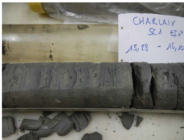
Figure 3 : Argiles litées de la couche F2ch, sur le sondage carotté SC1 de 2012, site de Charlaix. La surface a été raclée pour une meilleure observation du litage.
