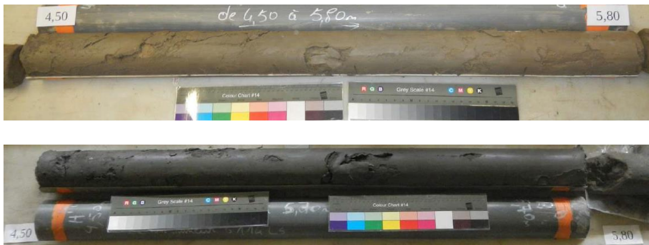
Figure 25 : Sondages de 2018 sur le site des Touches : (en haut) Echantillon carotté de la couche F1 issu du sondage S8-SC2-I3, 4.50 à 5.80 m de profondeur (en bas) Echantillon carotté de la couche F2 issu du sondage S8-SC2-I3 de 4.50 à 5.80 m de profondeur (photos Cerema)
