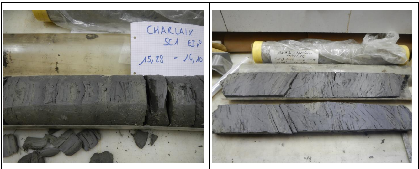
Figure 11 : Argiles litées de la couche F2ch, sur le sondage carotté SC1 de 2012 (photos Cerema, laboratoire d'essais). À gauche : aspect normal des varves avec alternances silteuses (gris-vert) et argileuses (gris-noir) au-dessus de la surface de rupture. À droite : lits désorganisés au niveau de la surface de rupture vers -16.0 m.
