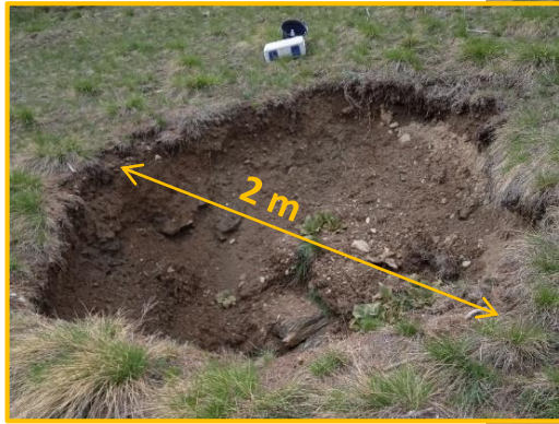
Entonnoir apparu entre 2013 et 2018 (profondeur aval > 1 m)
