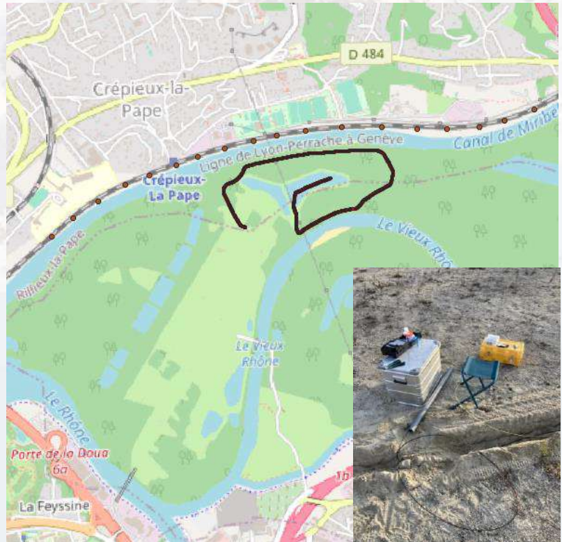
2 km de fibre déployé en surface (20cm)
