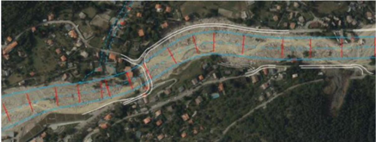
Figure 21 : Esquisse d'une préconisation de reconstruction des routes à 50-60 m du lit au niveau du Boréon à Saint Martin Vésubie par le RTM ( Queffeleau et al., 2022 ).
