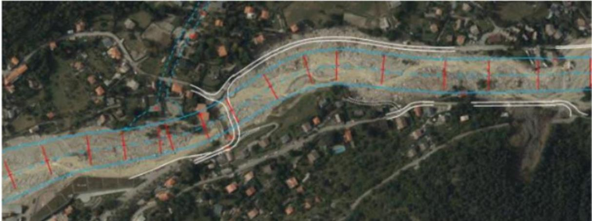
*Figure 21 : Esquisse d'une préconisation de reconstruction des routes à 50-60 m du lit au niveau du Boréon à Saint Martin Vésubie par le RTM ([Queffeleau et al., 2022](#)).*
