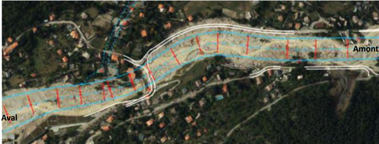
Préconisation de reconstruction des routes à 50-60 m du lit sur le Boréon par le RTM (Queffelean et al. , 2022)
