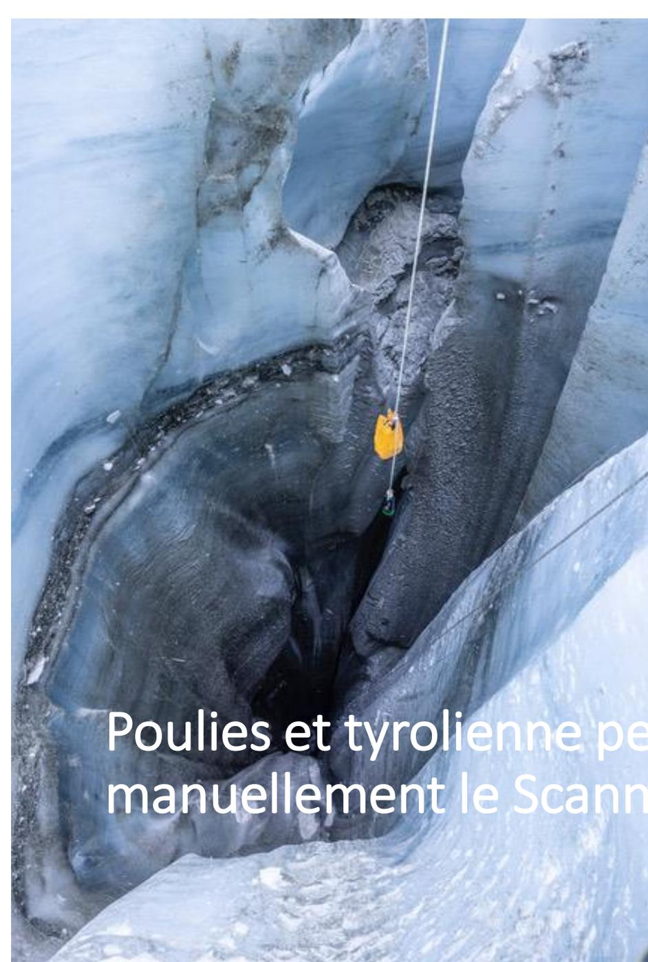
Poulies et tyrolienne permettent de descendre manuellement le Scanner au milieu du puits
