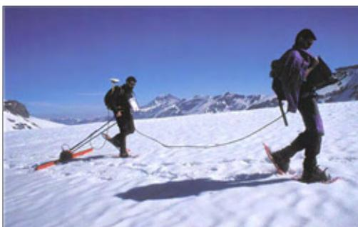
Des sondages sont réalisés sur différents parcours, représentés sur la photographie ci dessous, avec un système radar (photo de gauche). Le recoupement des différents profils obtenus sur les parcours permet d'estimer la position de la surface du socle rocheux sous le glacier.
