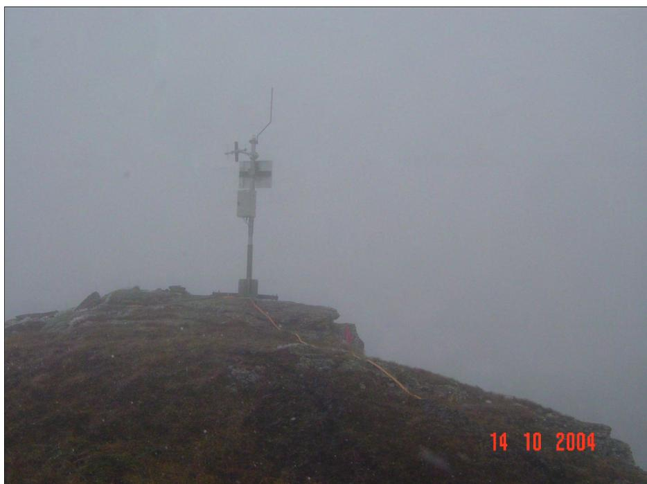
▲ *Le relais du Mont Cenis, chargé de la liaison radio permanente entre la station de mesures installée au lac et le PC du barrage*
