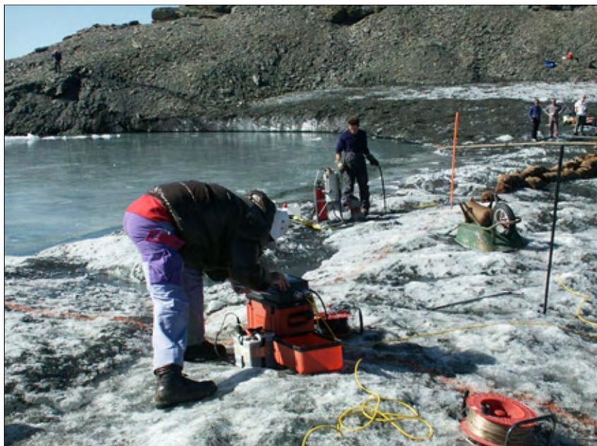
▲ *Au premier plan, mise en place du matériel pour les mesures sismiques. A l'arrière plan, forage à la sonde à vapeur. Au total douze forages seront réalisés dont cinq au bord du lac.*
