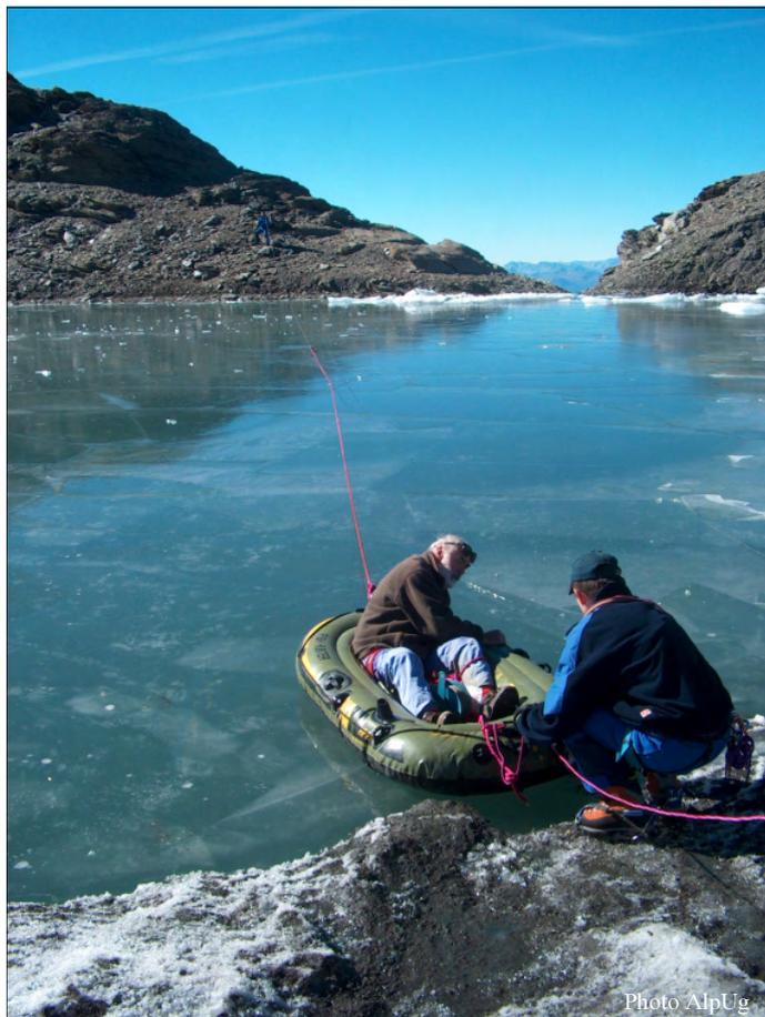
*Quelques mesures de bathymétrie et de température sont faites par le LGGE le 30 septembre 2004 à partir d'un canot pneumatique. La température du lac est de  $1 \pm 0.1$  °C, ce qui est assez élevé pour creuser très vite une importante bédrière en cas de surverse non contrôlée. ▲*
