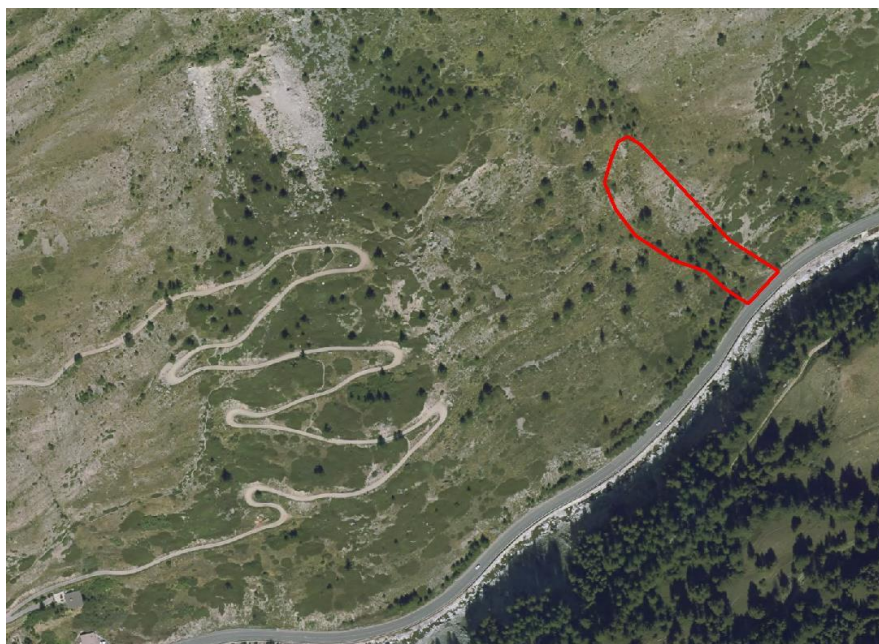
Figure 17 : Evolution du glissement et zone nouvellement déstabilisée suite aux réactivations de 2017.
