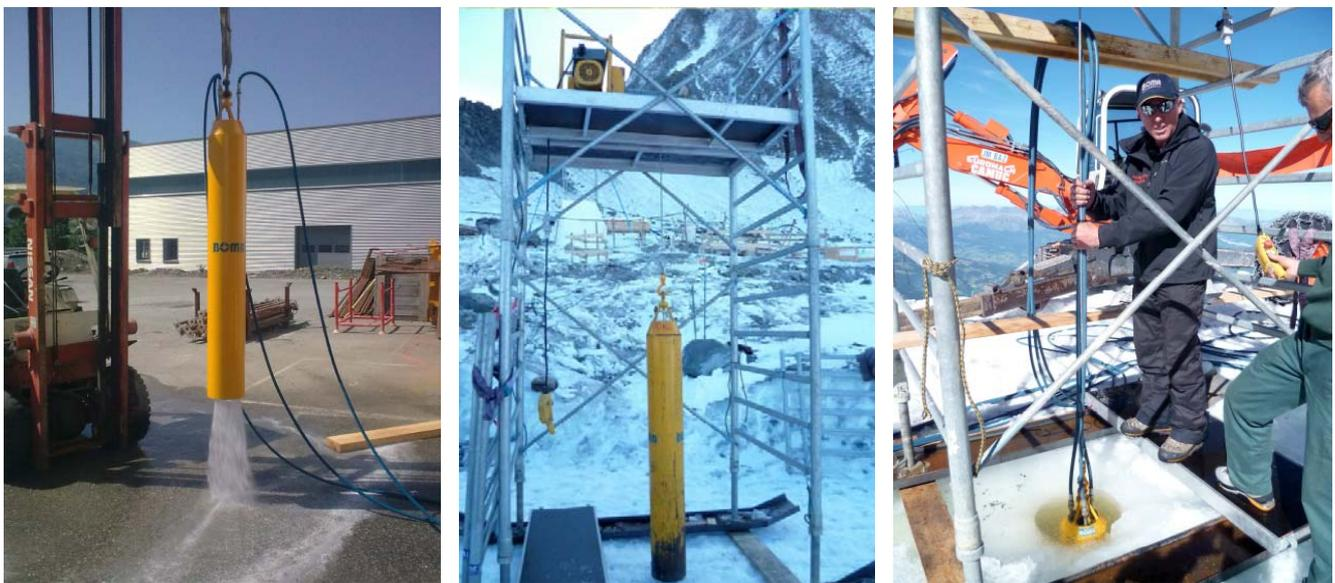
Fig. 20. Le forage à l'eau chaude sous pression (brevet BOMA)
