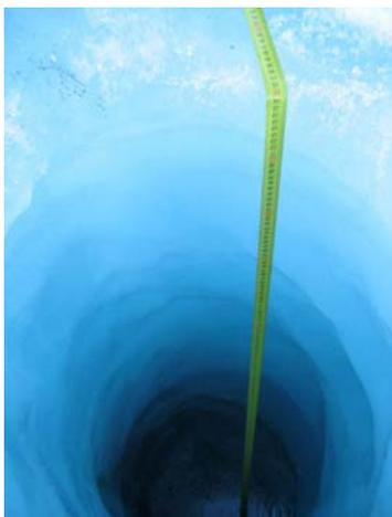
La vitesse d'avancement était de 5 à 10 m/heure, pour un puits de 50 cm de diamètre (Fig. 21). Le premier puits a atteint la cavité mercredi 25 août à 21h30.
