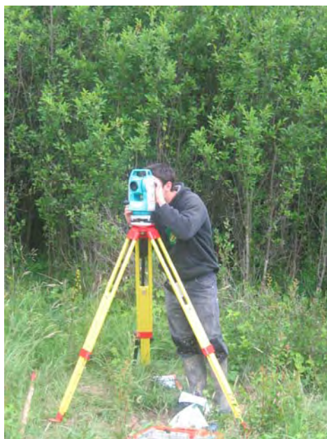
Figure II.5 : Photographie de la station totale SOKKIA SET.6
