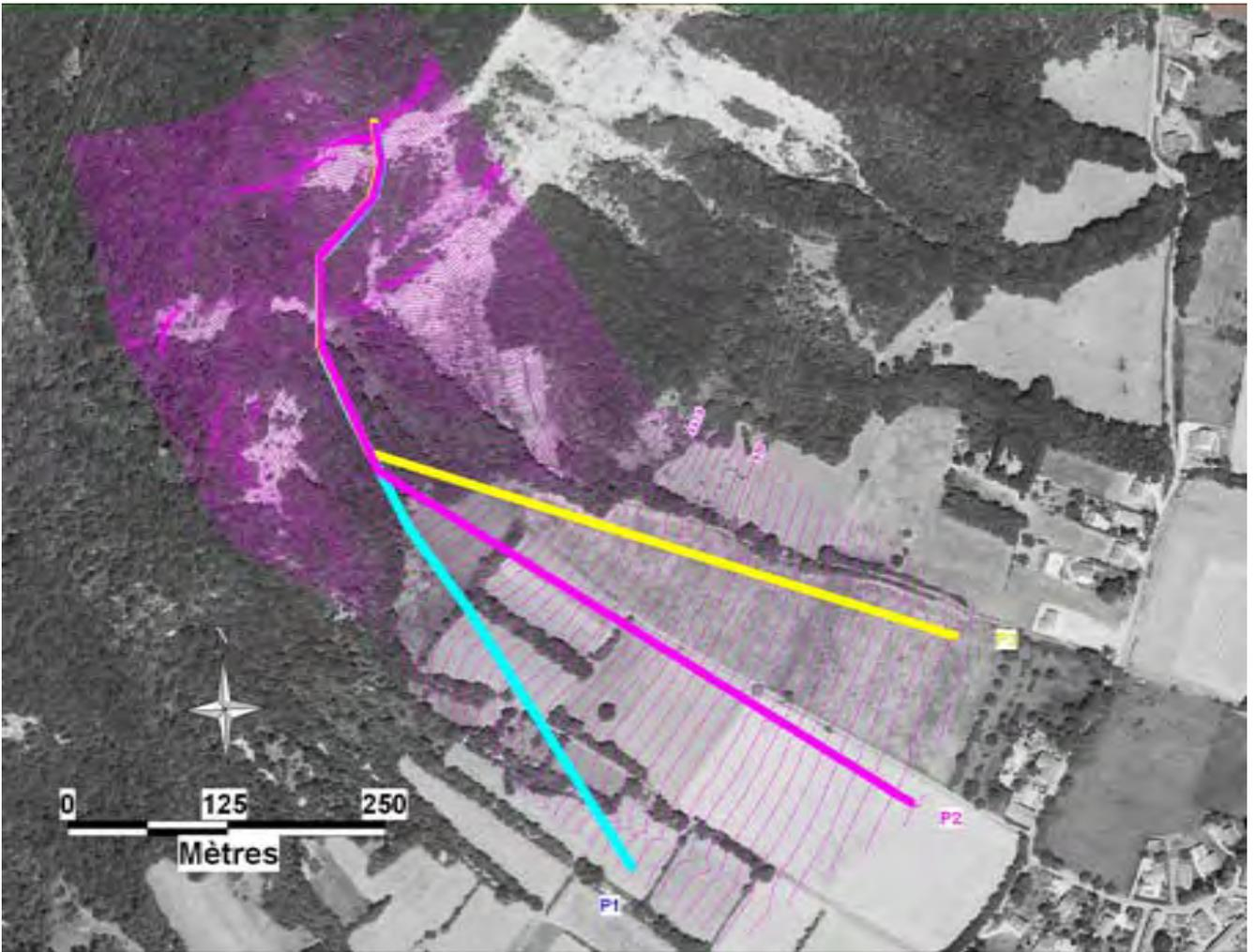
Fig. 7 : Délimitation de l'emprise de la zone de simulation pour le modèle en 3D et implantation des profils en long pour l'utilisation des modèles en 2D.
