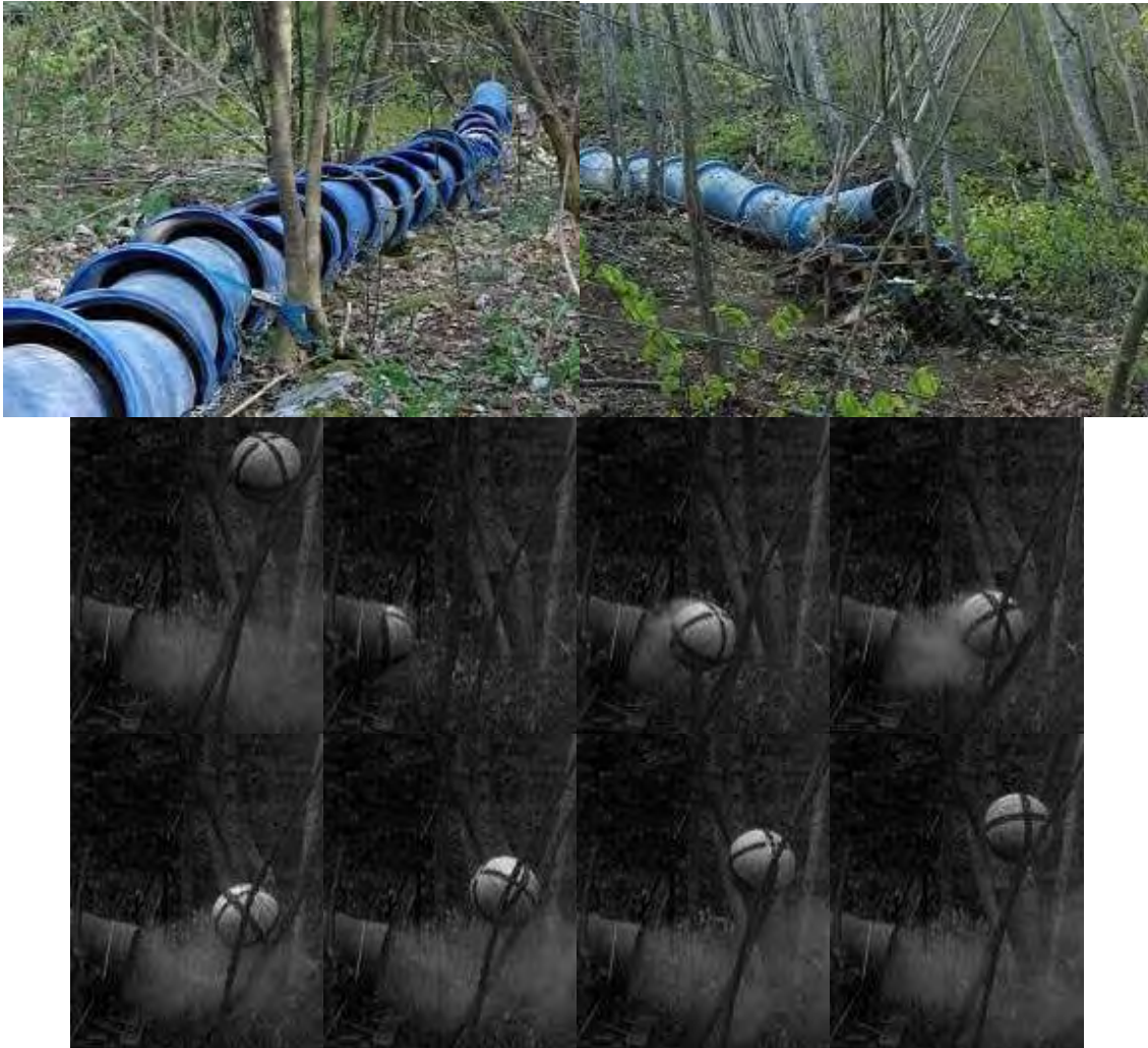
Figure 12 : Présentation du dispositif expérimental in situ d'impact d'une sphère de granit sur un brin de taillis et exemples d'images réalisées avec une caméra à prise de vues rapides
