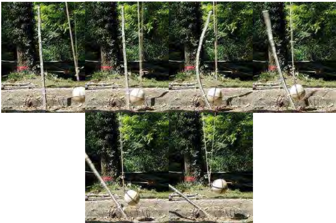
Figure 11 : Présentation du dispositif expérimental d'impact d'une sphère de béton sur un brin de taillis de 3m de haut prélevé en forêt et exemples d'images réalisées avec une caméra à prise de vues rapides
