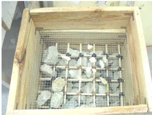
Figure 8. Tamisage à sec de l'échantillon de sol.
