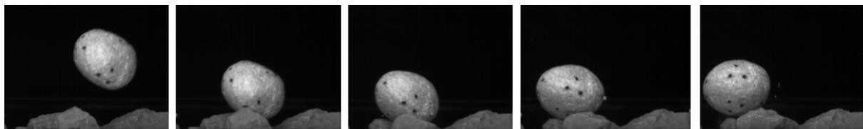
Figure 16. Zoom d'images brutes issues du film à la caméra rapide d'un essai. Lors de l'impact, l'impactant est caché par les pierres de l'éboulis. Le mouvement des points marqués sur l'impactant met en évidence la rotation de l'impactant.
