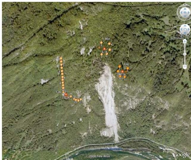
Figure 1 : Plan du réseau sismologique. Les capteurs verticaux sont représentés par un rond, et les 3 composantes par un triangle. Les capteurs 1 à 12 de la station GAL sont localisés à l'intérieur de la galerie.
