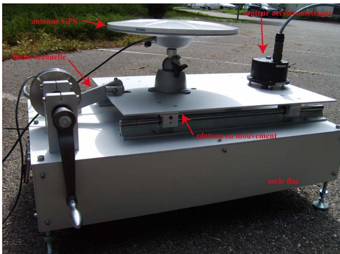
Figure 4: Banc de test réalisé au LGIT en 2008 pour l'acquisition de données GPS haute-fréquence couplée avec des mesures sismologiques (réalisation technique : J.-P. Masson, N. Cotte et M. Langlais, avec la participation de S. Hatton et B. Vial)
