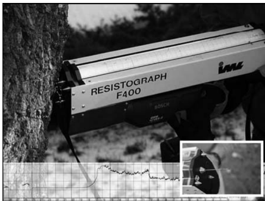
Figure 3. Unité de forage du résistographe "IML Resi F400"
