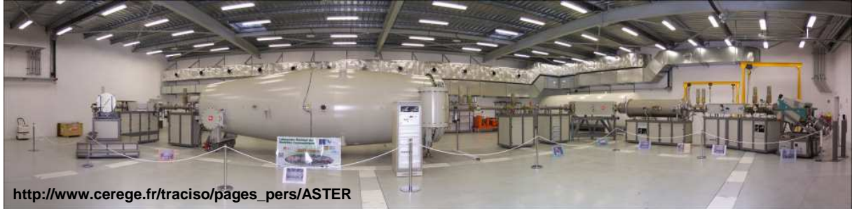
Figure 2. Accélérateur du CEREGE (Aix-en-Provence) utilisé pour déterminer la quantité de cosmonucléides contenue dans les roches.
