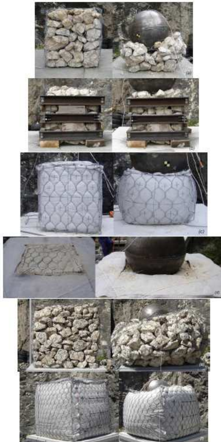
Figure 6 : vue des cellules avant et après impact : cellules 500 granulats non confinée, et confinée, cellule 500 sable non confinée et confinée matériau, cellule 1000 non confinée granulat et sable.
