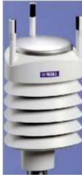
Sonde Vaisala WXT510 incluant le disdromètre mécanique RAINCAP
