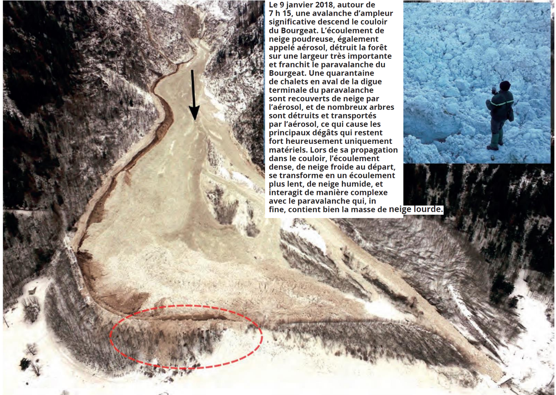
Figure 3 : dépôt de l'avalanche dans le paravalanche du Bourgeat (©Mairie Les Houches). L'ellipse tracée en pointillé rouge montre la zone des débordements mineurs, là où une langue d'avalanche s'est propagée le long de la digue avec une hauteur supérieure à la digue. L'image insérée (©Irstea-Thierry Faug) montre un zoom du dépôt illustrant ainsi le caractère granulaire de ce dépôt et la taille importante de certains agrégats de neige (à comparer à l'échelle donnée par la personne).
