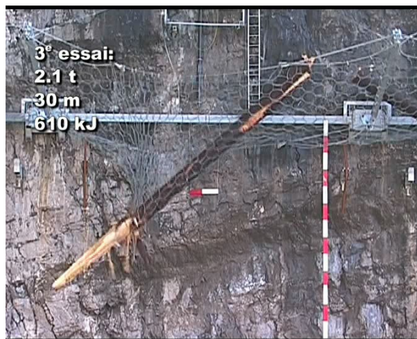
Essai d'impact de tronc d'arbre
