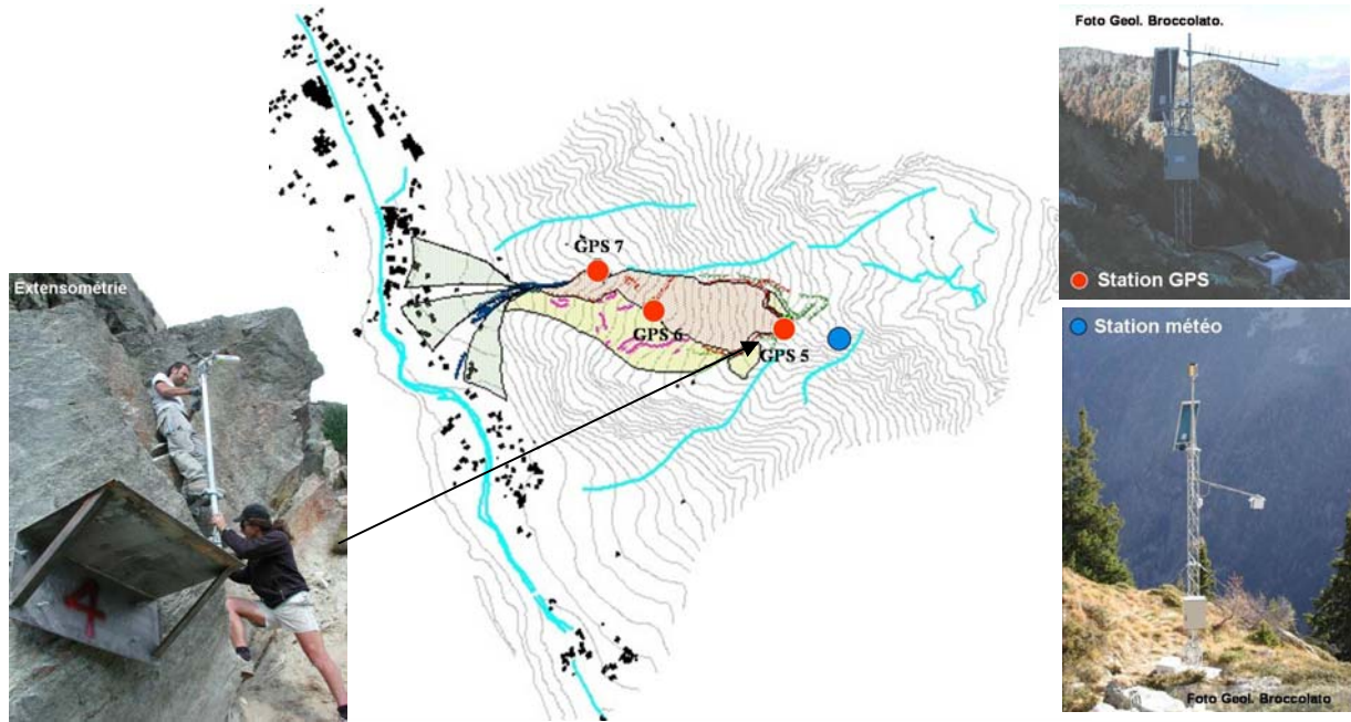
Disposition des instruments automatiques de surveillance
