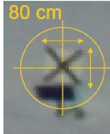
Fig. 6. Mire de calage au Lautaret vue à 900 m de distance de la caméra.
