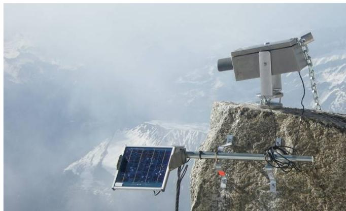
Fig. 4. Panneau solaire et coffret abritant un des appareils photo (site de Taconnaz)
