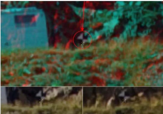
Fig. 13. Position du pointeur sur une mire non utilisée pour l'aérotriangulation : le logiciel positionne le pointeur sur la position théorique (obtenue par GPS) à environ 10 cm de la position obtenue par orientation.
