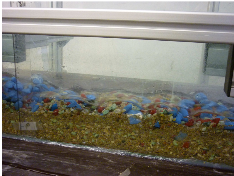
Figure 2 : Transport solide à forte pente dans le canal expérimental du Cemagref (Expérience en granulométrie étendue)
