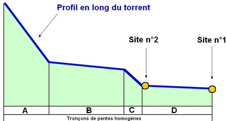
Dans cet exemple, le tronçon D étant moins raide que les tronçons supérieurs, une régulation naturelle des apports issus de l'amont s'opère dans ce bief par le biais d'un stockage des matériaux amenés par excès depuis les biefs amont. L'intensité des apports sédimentaires au droit du site n°1 est donc déterminée par la capacité de transport solide du tronçon D. La pente du tronçon D conditionne de ce fait les apports solides du torrent au droit du site n°1.
