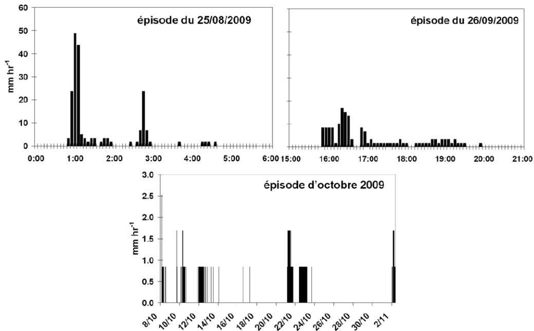
Figure 24. Hyétogrammes des épisodes pluvieux d'août, septembre et octobre 2009 mesurés dans le haut bassin du Manival (intensités mesurées selon un pas de temps de 5 mn)
