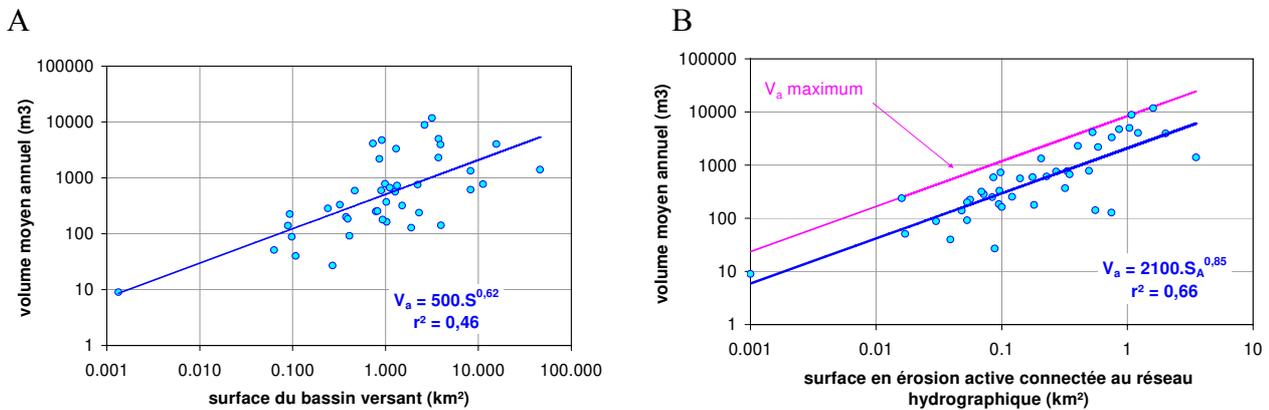
Figure 8. (A) Production sédimentaire en moyenne annuelle en fonction de (A) la taille du bassin versant et (B) de l'étendue des zones en érosion active connectées au réseau hydrographique
