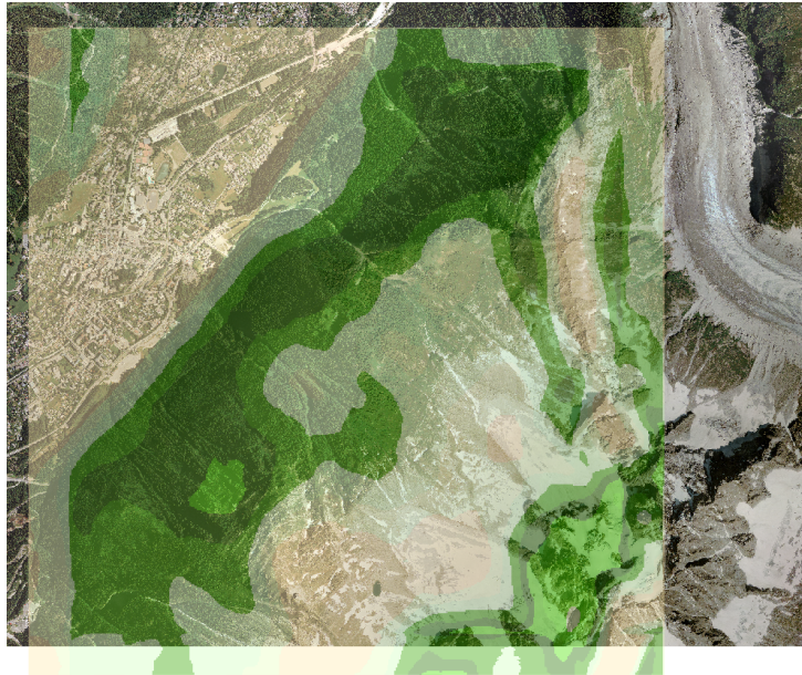
FIG. 11 – Propension aux départs d’avalanche, selon la pente, sur un relief filtré à 300 m. La pente est calculée par ArcGIS sur un voisinage 3 \times 3 , par un simple calcul de différences. Appliqué à une image lissée, cet algorithme livre des pentes vues à l’échelle correspondante. L’image obtenue est à son tour filtrée selon le principe d’une LUT ( lookup table ) : la valeur de chaque pixel (une pente en degrés) est transformée en son image par la fonction figure 4 page 21, avec pour résultat une image où les tendances aux départs d’avalanches sont affichées en un vert d’autant plus sombre qu’elles sont fortes. L’orthophotoplan est visible par transparence, il aide à se situer en contexte, lui et la zone d’affichage des résultats se débordent mutuellement pour qu’on puisse voir les couleurs de chacun sans mélange.
