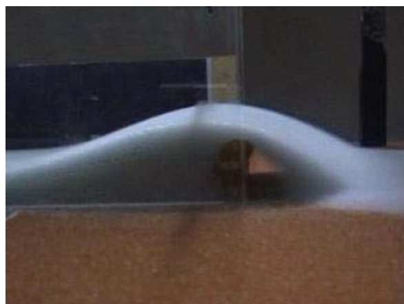
Figure 2. Avalanche interagissant avec la digue
