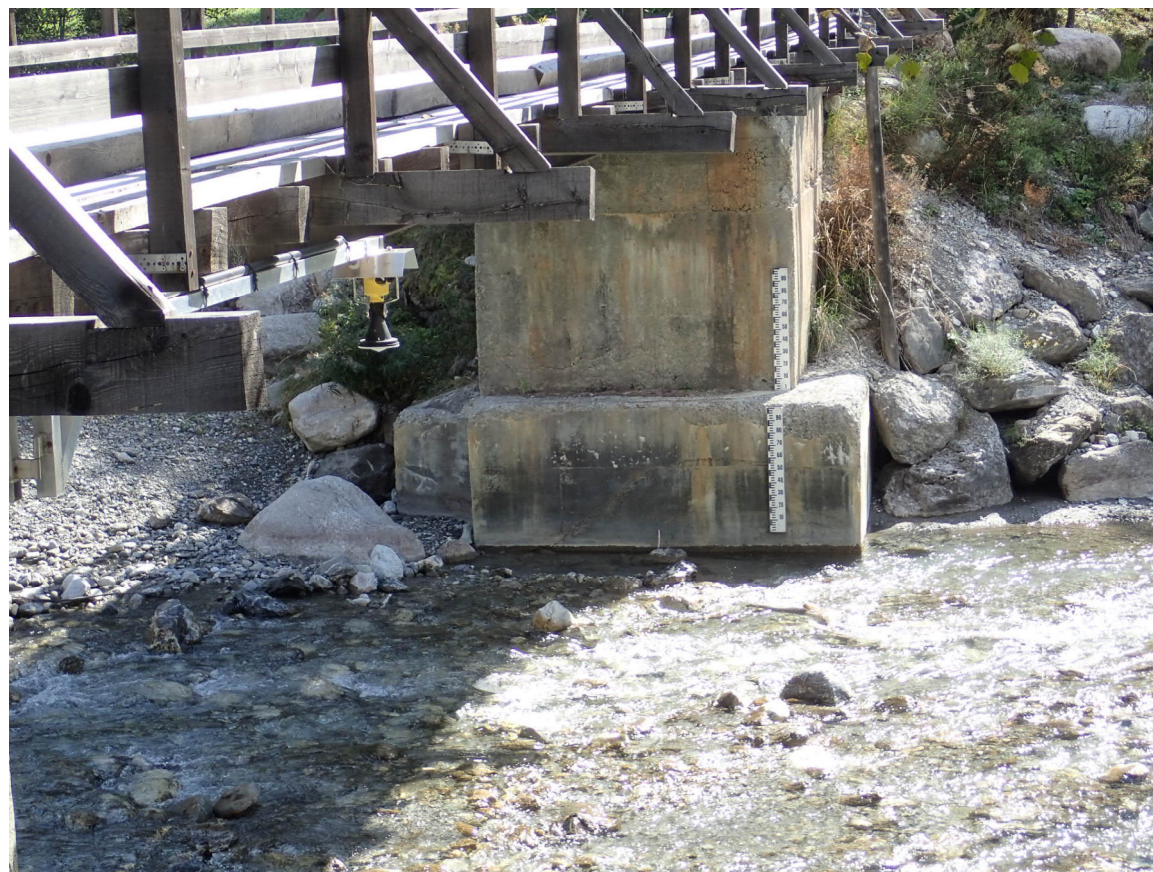
Capteur de niveau implanté sur une passerelle – Ubaye - St Paul Sur Ubaye (04)
