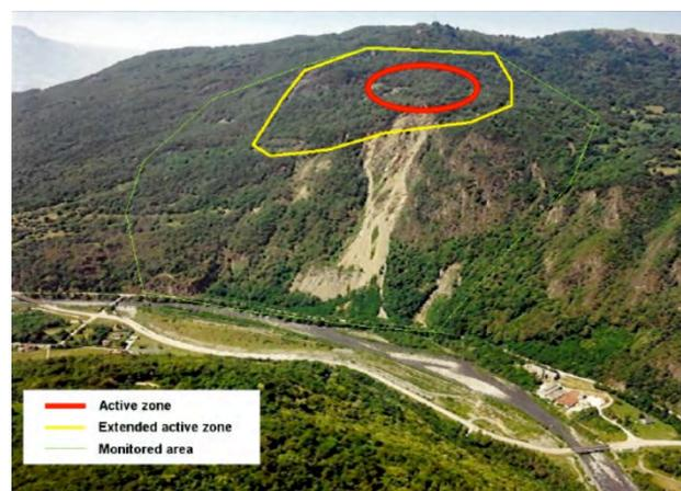
Fig. 2 : Zone considérée dans les scénarios futurs d'éboulement en masse des Ruines de Séchilienne (source : Hergat 2003 - projet NEDIES)
