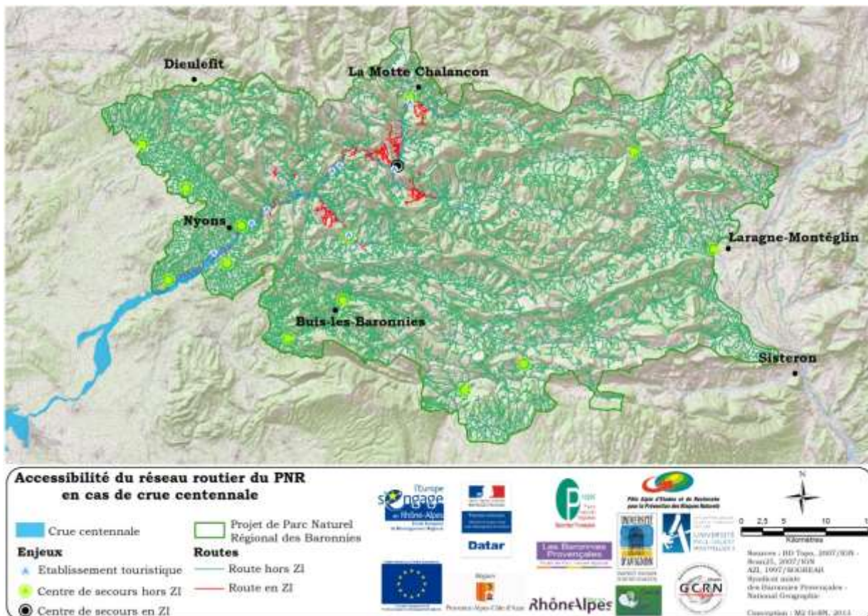
Figure 37 : Carte d'accessibilité du réseau routier du PNR en cas de crue centennale
