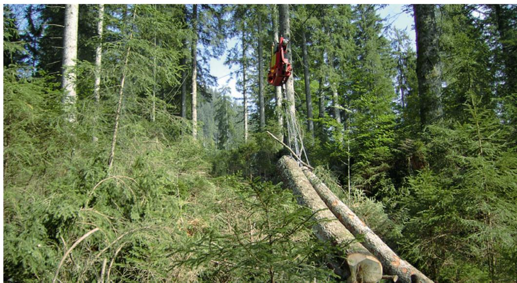
Des fûts d'arbre sont transportés au moyen d'une grue à câble sur un terrain pentu en direction d'un chemin forestier.<sup>8</sup>
