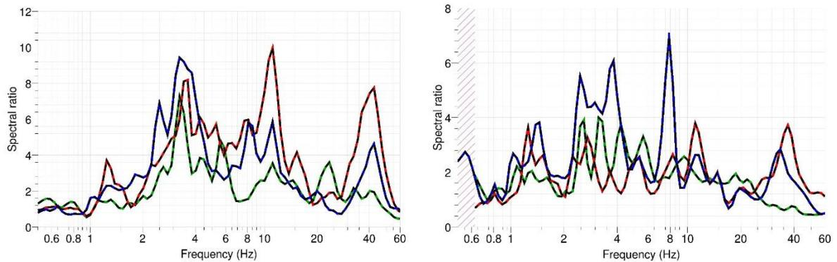
Figure 13. Rapport spectraux entre 0.5 et 60 Hz par rapport à OGS3 pour les composantes Est-Ouest (rouge), Nord-Sud (bleu) et verticales (vert). A gauche, OGS1 et à droite OGS2 (données vélocimétriques).
