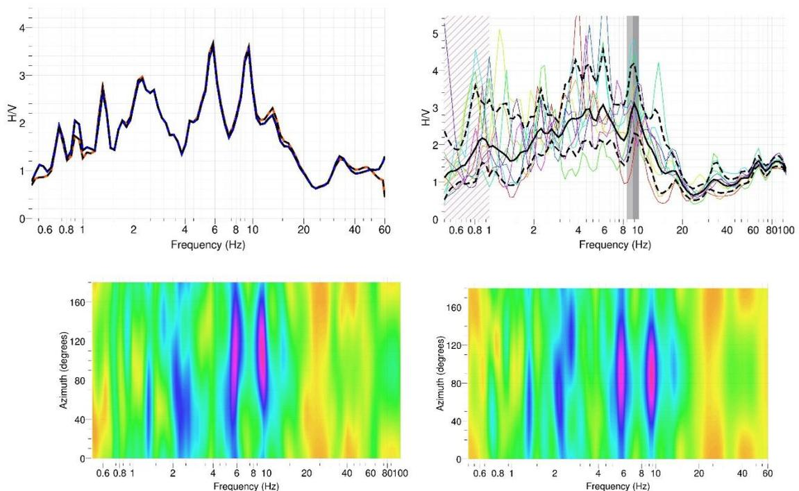
Figure 6. Analyses H/V sur le velocimètre OGS1 (bleu) et l'accéléromètre (rouge). Une seule fenêtre temporelle (70 s, gauche) et 9 fenêtres temporelles (10 s, droite) ont été utilisées pour le velocimètre. En bas, anisotropie de la réponse H/V par rapport à l'orientation N-S pour velocimètre (gauche) et accéléromètre (droite).
