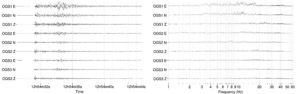
Figure 12. Réponses vélocimétriques (gauche) et contenu fréquentiel associé (droite) du séisme de SASSENAGE.
