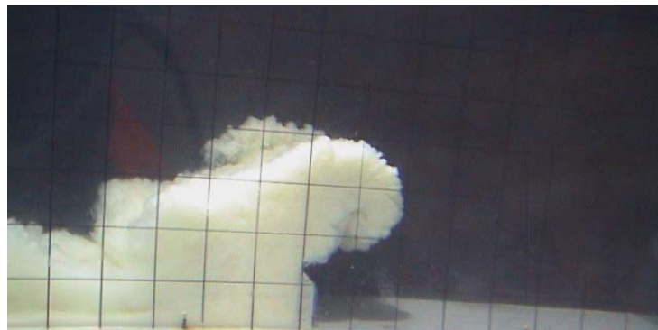
Figure 9 : Simulation en bassin noyé de l'interaction entre une avalanche de neige poudreuse et la digue frontale (du type de celle de Taconnaz)
