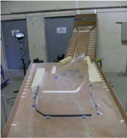
Figure 7 : Modèle réduit en laboratoire de la zone d'arrêt inclinée à 13° et alimentée en matériau granulaire à l'aide d'un canal de pente ajustable (source : Cemagref)
