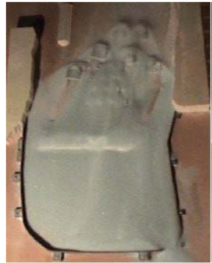
Figure 8 : Dépôts obtenus par les expériences en modèle réduit (Source : Cemagref)
