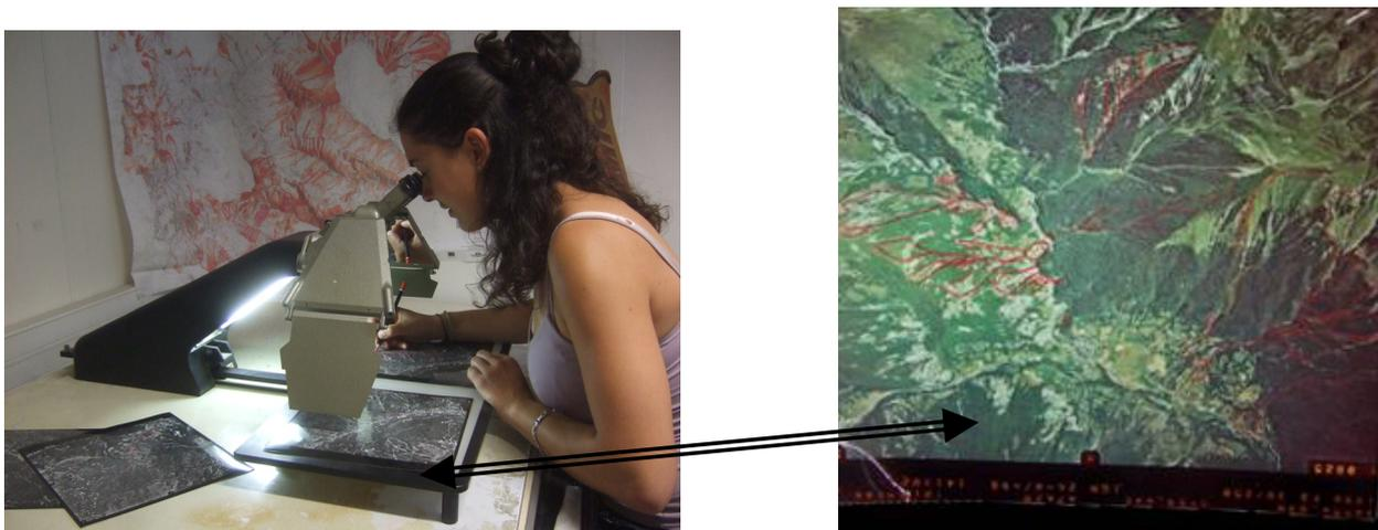
Figure 3 : Travail de photo-interprétation à l'aide d'un stéréoscope (à droite : vue rapprochée d'un cliché)
