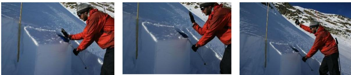
Figura 16 : La sobrecarga se efectúa igual que en el test de la compresión. Foto: Jordi Gavalrà
