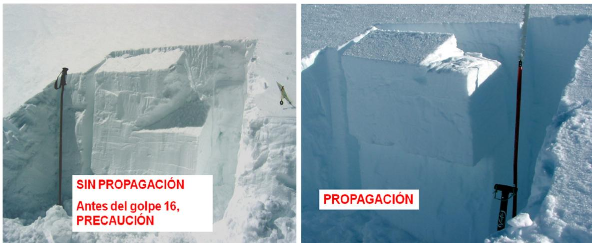
Figura 17 : Izquierda, test de la columna extendida sin propagación de la fractura.
