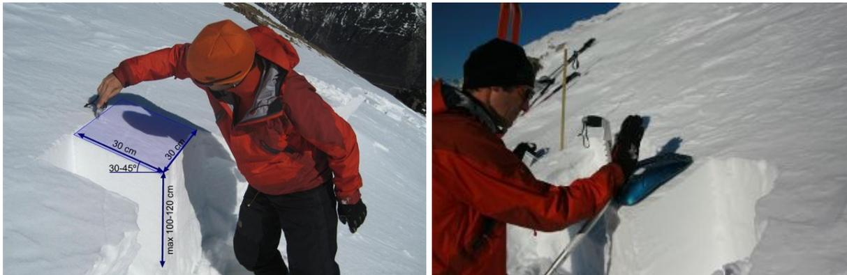
Figura 13 : A la izquierda, medidas del bloque para la realización del test de la compresión. A la derecha, primero se golpea con la punta de los dedos. Fotos: Jordi Gavalrà e Ivan Moner
