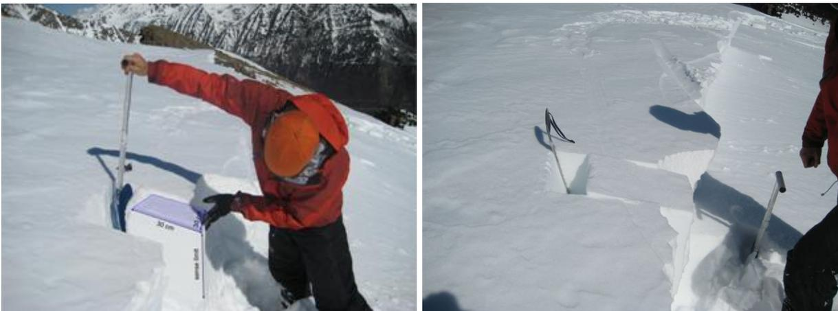
*Figura 7 : Medidas y procedimiento del test de la pala. Fotos: Ivan Moner*
