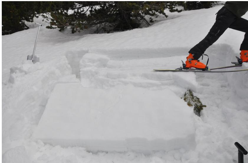
*Figura 11 : Deslizamiento del bloque tras sobrecargarlo con los esquís.*
