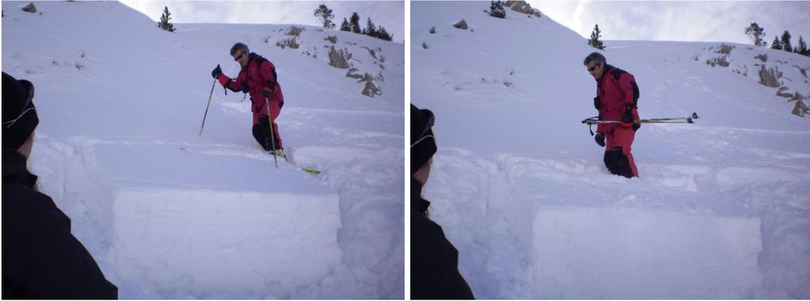
*Figura 9 : La sobrecarga se efectuará en la parte central del tercio superior del bloque aislado.
