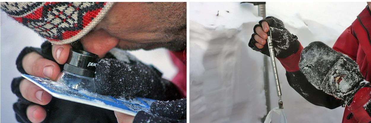
Fotos 4 y 5 : Perfil estratigráfico. Observación del tipo de grano y densidad de capa (autor: Ramon Baylina).
