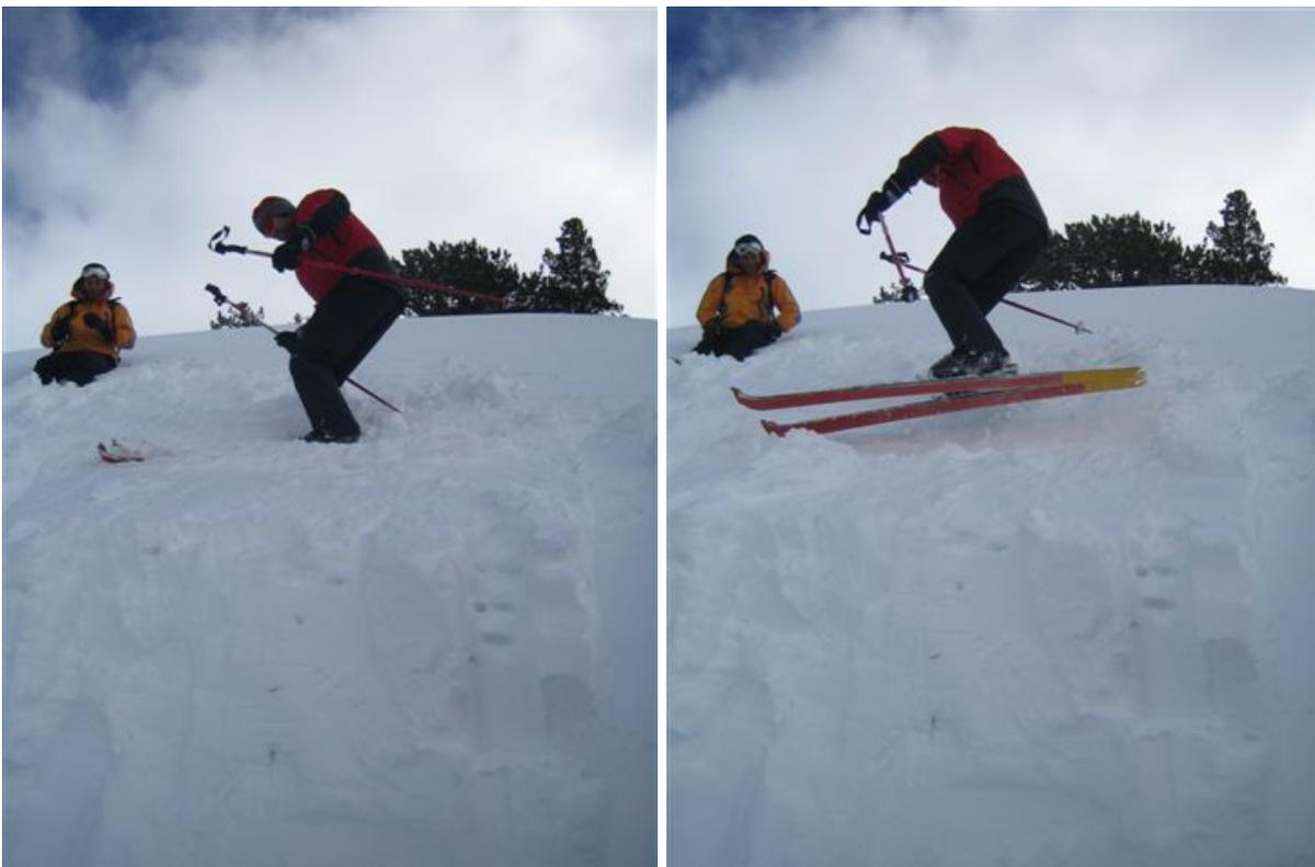
*Figura 10 : Primero se efectúa una flexión. Si el bloque no cede, procedemos a efectuar un salto.
