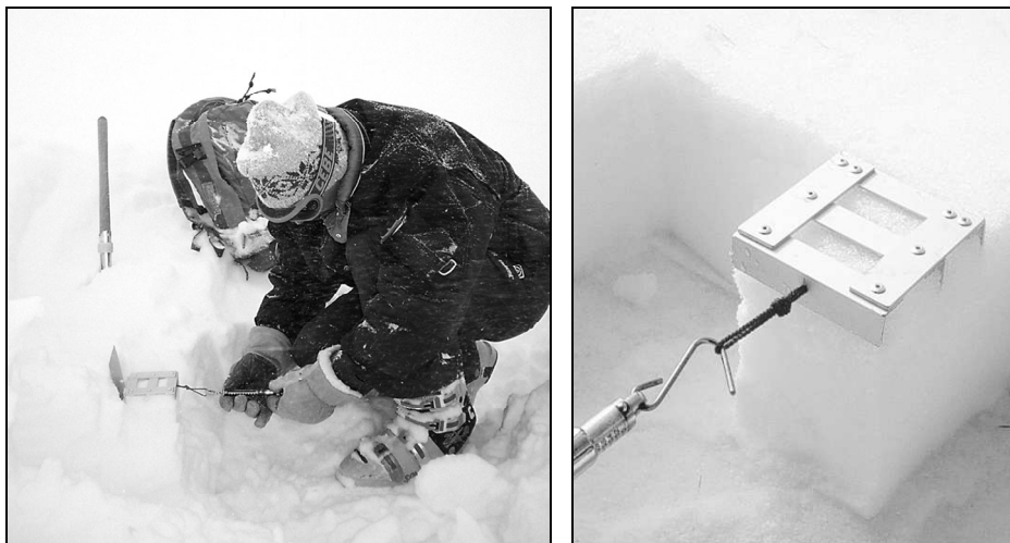
Figure 7 : Mesure de résistance au cisaillement, accompagnée d'un test manuel de dureté (campagnes de mesures METEORISK)
