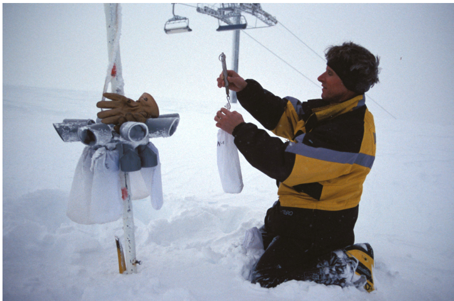
Figure 3 : Mesure du transport de neige par le vent à l'aide d'un driftomètre, à un poste d'altitude.
