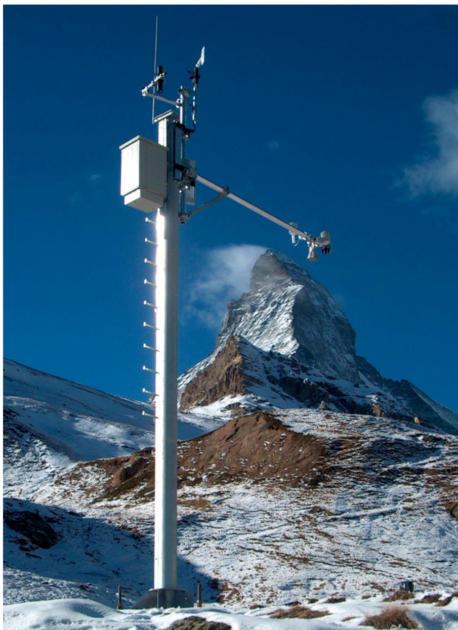
Figure 6 : station « neige » pour les prévisions d'avalanches (Zermatt – Alp Hermetje, Valais – Suisse, 2380 m).
