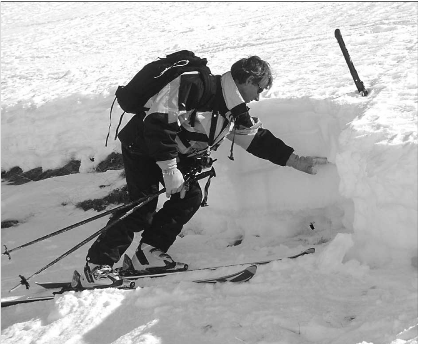
Figure 6 : Réalisation d'un profil nivologique simplifié (responsable du service des pistes des Deux-Alpes) : un relevé adaptée aux réalités du terrain,
