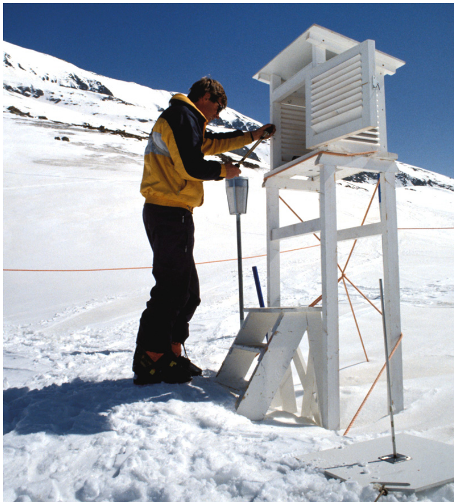
Figure 2 : Poste de mesures traditionnel avec abri ventilé ; on distingue le pluviomètre et la planche à neige.
