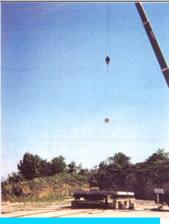
Essai de chute de bloc
